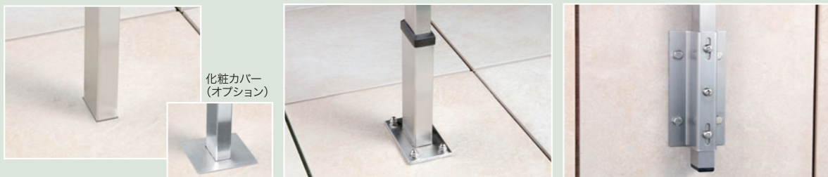
埋込タイプ支柱 ※傾斜地には取付け不可 ベースプレート(床面)タイプ支柱 ※注意 アンカーボルトで支柱を固定するため、下地はRC造であることをご確認ください。 側面付けタイプ支柱
