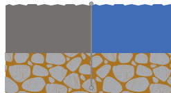
アスファルト舗装 同士の見切
