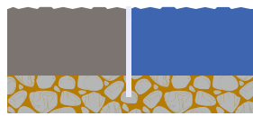
アスファルト舗装同士の見切
