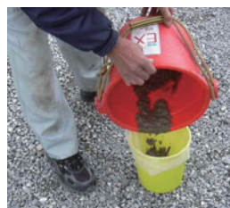
⑦残った凝集物をバケツ(小) に全部流し込む。
