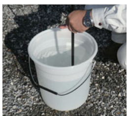
⑫攪拌して中和を促進させる。 30秒攪拌。
