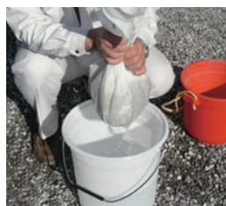
⑨ろ過紙(大)を持ち上げ 絞り、残った凝集物を現場 にて産業廃棄物として 処分します。 ※ろ過紙(大)は同梱して いるろ過紙(小)が無くな るまで、繰り返し(50回) 使用してください。
