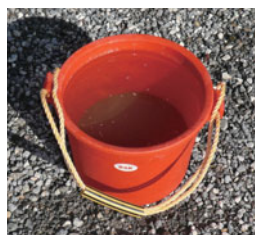
③水と凝集物とに完全に分離 したのを確認し、凝集が完了。
