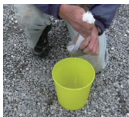
⑧ろ過紙(小)を持ち上げ絞り、 産業廃棄物として処分します。 残った水は、ペール缶に入れる。
